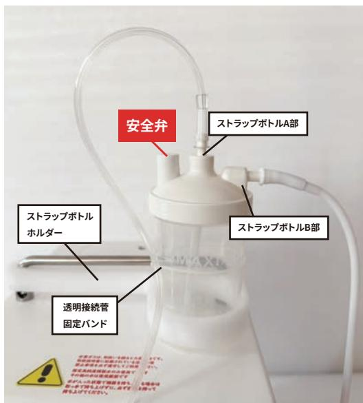
ストラップボトル、吸入管を接続します。
