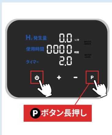
操作パネルの右下の循環ポンプ **P** ボタンを5秒長押ししてください。
