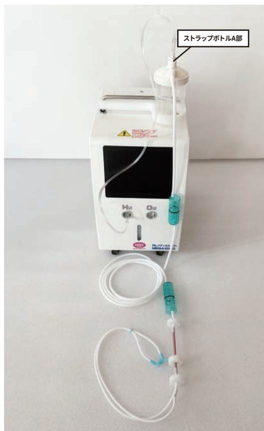
接続管、カニューラを接続します。左図のように接続してください。
