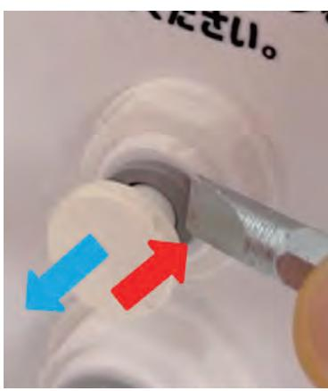
機器背面の残圧排気用ピンを取り外してください。
