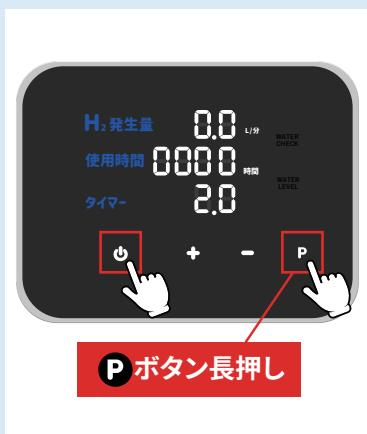
操作パネルの右下の循環ポンプ **P** ボタンを5秒長押ししてください。
